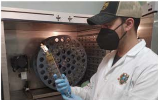
Figura 2. Método de producción de gas in vitro (Gas Test, Hohenheim, Alemania), utilizando jeringas de vidrio de 100 ml calibradas.
