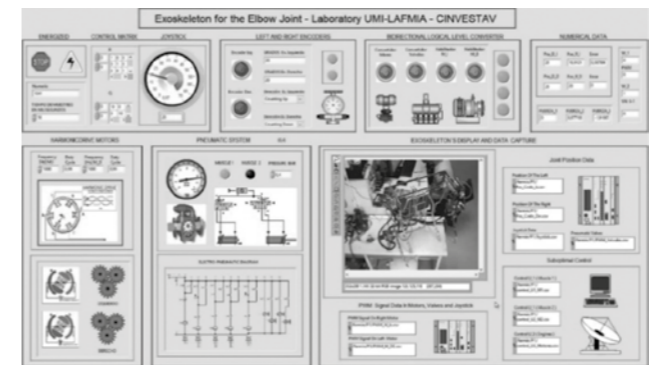
Figura 4. Panel de mandos del sistema eléctrico, neumático y almacenamiento de datos a distancia.
