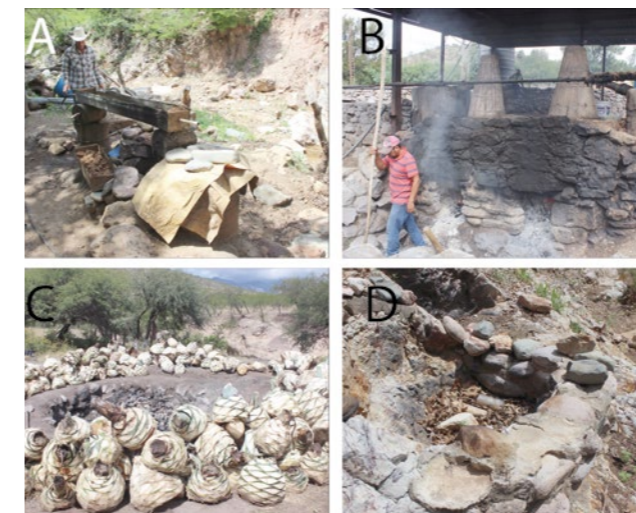
Figura 1. (A) destiladora filipina (tren), Pie de la Cuesta, Uruachi, Chihuahua, (B) destiladora filipina El Venado, Nombre de Dios, Durango, (C) pozo de cocción en vinata de mezcal Julik, con Agave durangensis , A. angustifolia y Dasyliirion durangense , Yonora, Mezquital, Durango, (D) pozo de fermentación improvisado en lecho de arroyo seco, Pie de la Cuesta, Uruachi, Chihuahua.
