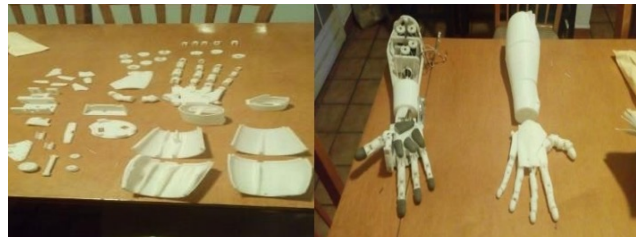
Figura 4. Armado de prototipo mioeléctrico (fuente: elaboración propia).
