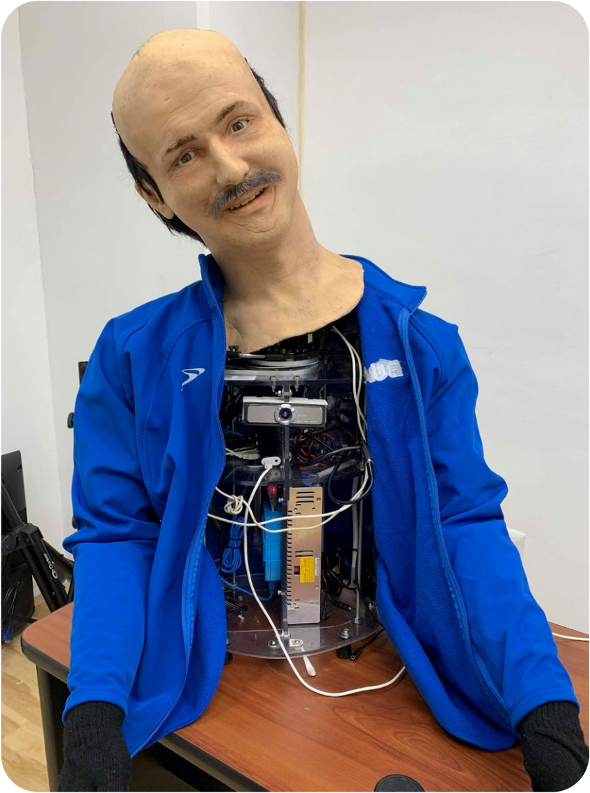
Figura 2. Un humanoide y sus componentes electrónicos.
