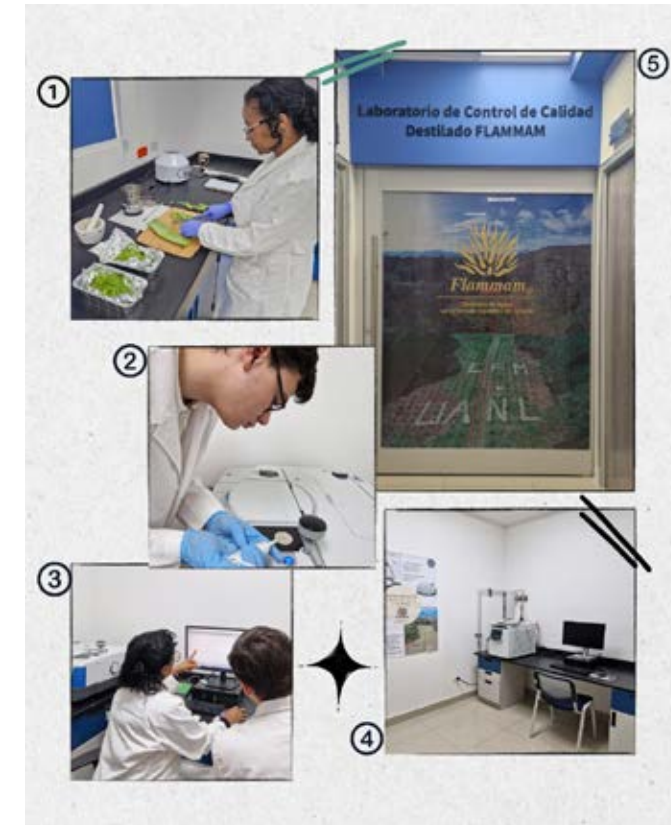
Figura 1. Áreas del Laboratorio de Análisis de Destilados de la UANL para el control de la calidad de Flammam . (1) Espacio de trabajo para muestras vegetales, (2) y (3) análisis de muestras por FTIR, (4) zona con cromatógrafo de gases-FID para determinar la calidad volátil, (5) entrada al laboratorio.
