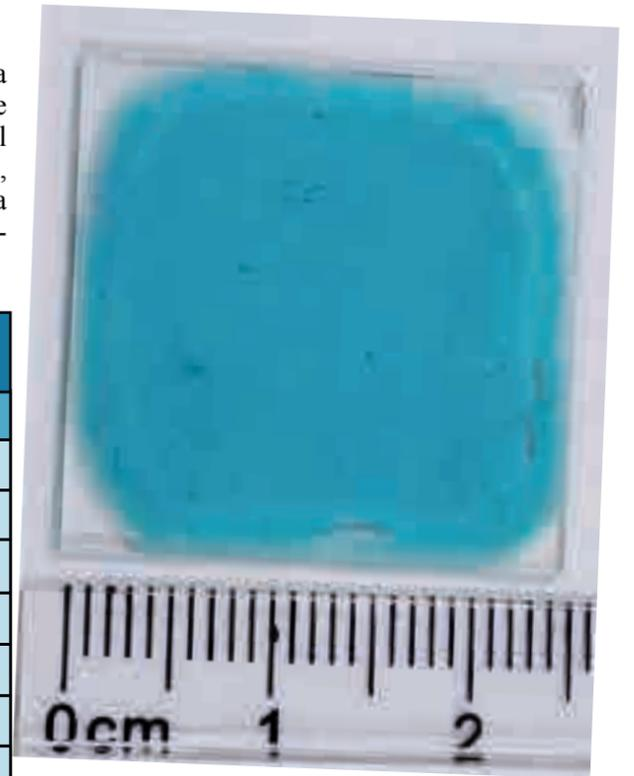
Figura 2. Película de nanoalambres de  $\text{Cu}(\text{OH})_2$ .
