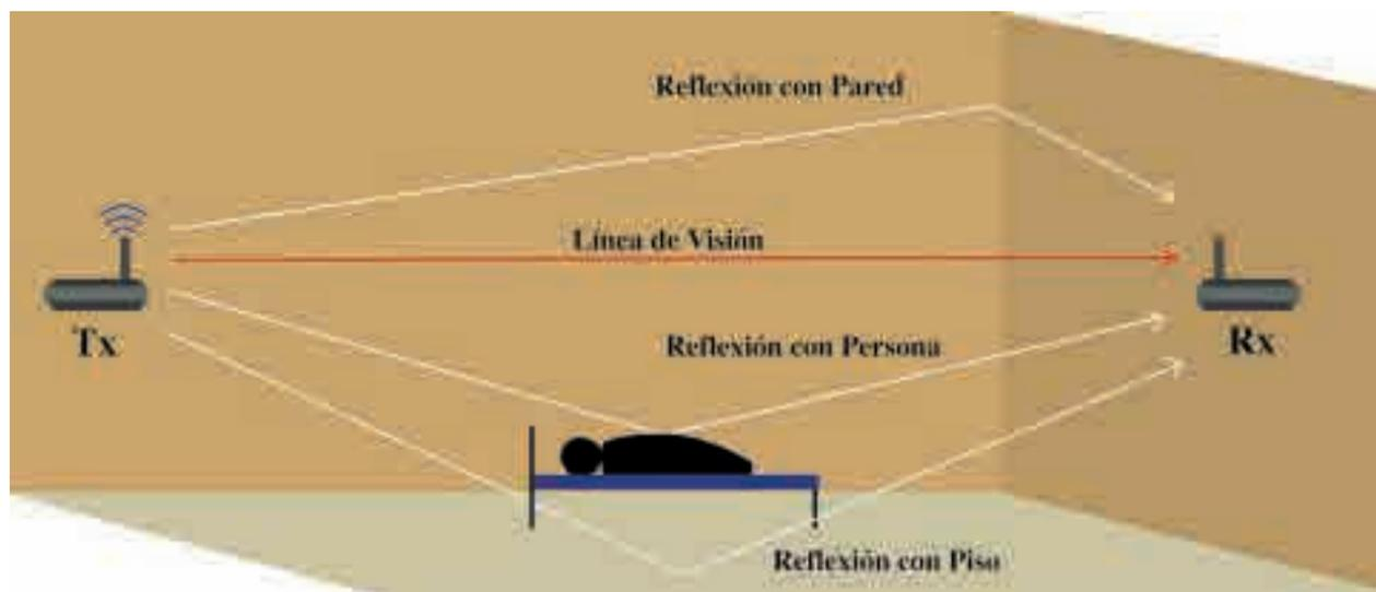
Figura 1. Propagación de señal por múltiples trayectorias.
