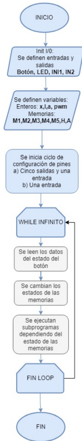
Figura 2. Diagrama de flujo del funcionamiento que muestra el algoritmo del microcontrolador (fuente: elaboración propia).
