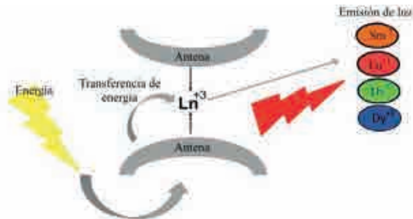
Figura 4. Efecto antena en compuestos de coordinación con iones lantánidos
