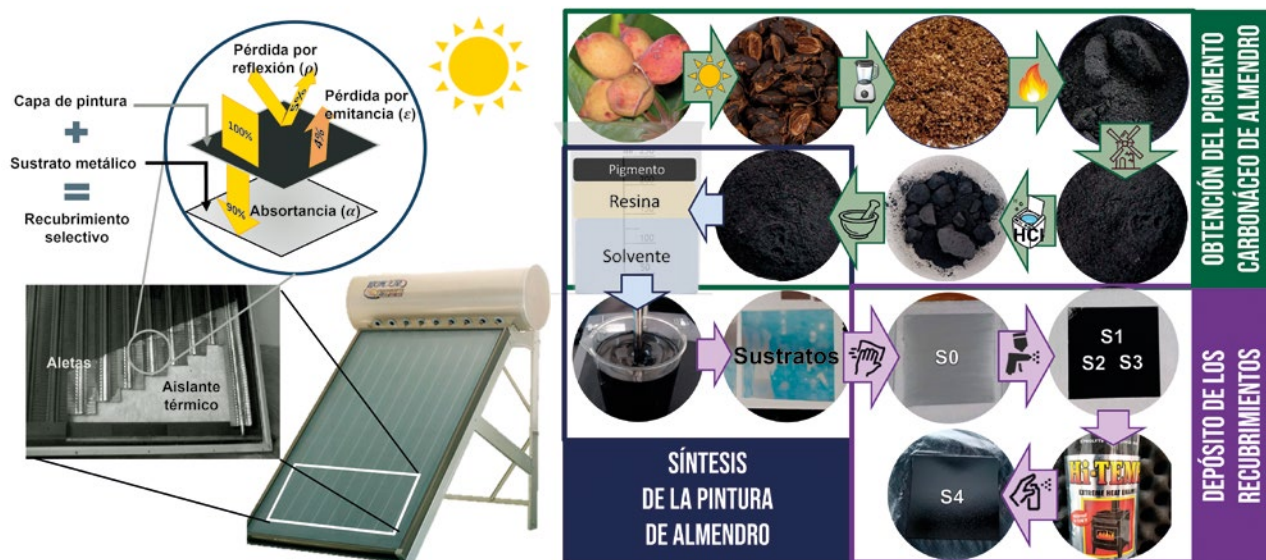
Figura 1. a) Representación gráfica de la funcionalidad de los recubrimientos absorbentes solares (SAC) en los calentadores de placa plana. b) Diagrama de flujo metodológico.
