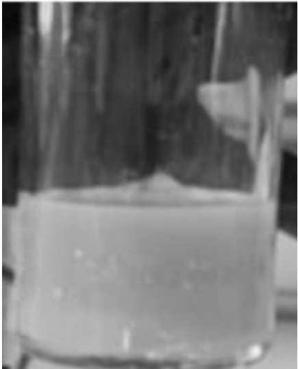
Figura 1. Microemulsión keroseno (6%), agua (76.9%), etanol (15.2%) y mono-ramnolípidos (1.9%) obtenidos de P. aeruginosa .
