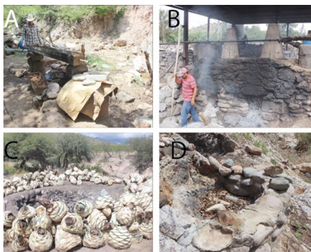
Figura 1. (A) destiladora filipina (tren), Pie de la Cuesta, Uruachi, Chihuahua, (B) destiladora filipina El Venado, Nombre de Dios, Durango, (C) pozo de cocción en vinata de mezcal Julik, con Agave durangensis , A. angustifolia y Dasyllirion durangense , Yonora, Mezquital, Durango, (D) pozo de fermentación improvisado en lecho de arroyo seco, Pie de la Cuesta, Uruachi, Chihuahua.
